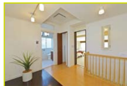
[吹き抜け、高窓の新設]”風”コントロールの核となる2階踊り場。1階地窓から取り込んだ風を2階吹き抜け経由で高窓に逃がす。この吹き抜けは、冬場は暖房効果を保つために閉めることも可能
